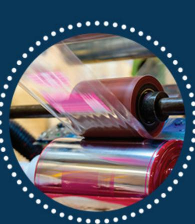
Utiliza rolos e camisas (sleeves) contra-pressor Böttcher, inclusive com ESA (sistema de assistência elétrica) e rolo entintador (pescador) com perfil gravado à laser.
